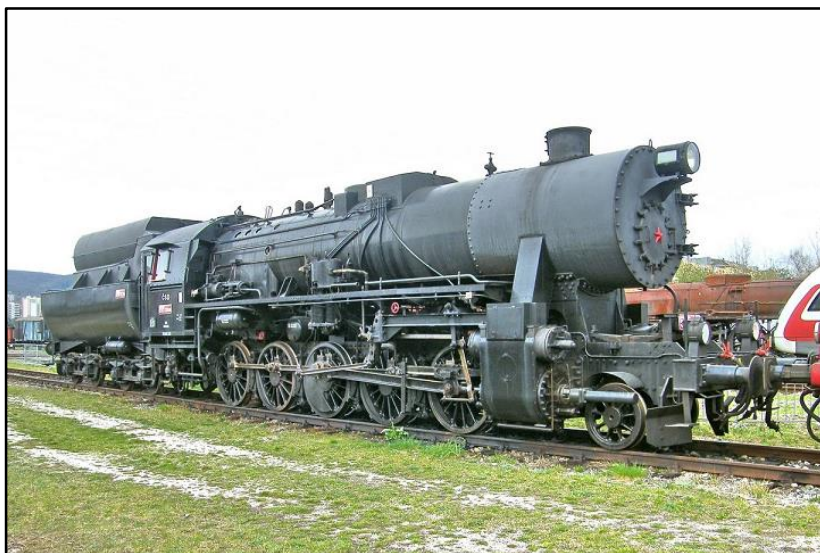
Zatiaľ posledným, dobrovoľnícky z úplného vraku sprevádzkovaným rušňom bola Mazutka 555.3008, ktorej oprava prebiehala v rokoch 1999 – 2011. Rušeň vďaka vykurovaniu vykurovacím olejom nepotrebuje, aby bol za jeho parným vlakom zavádzaný požiarny vlak © archív ŽM SR
