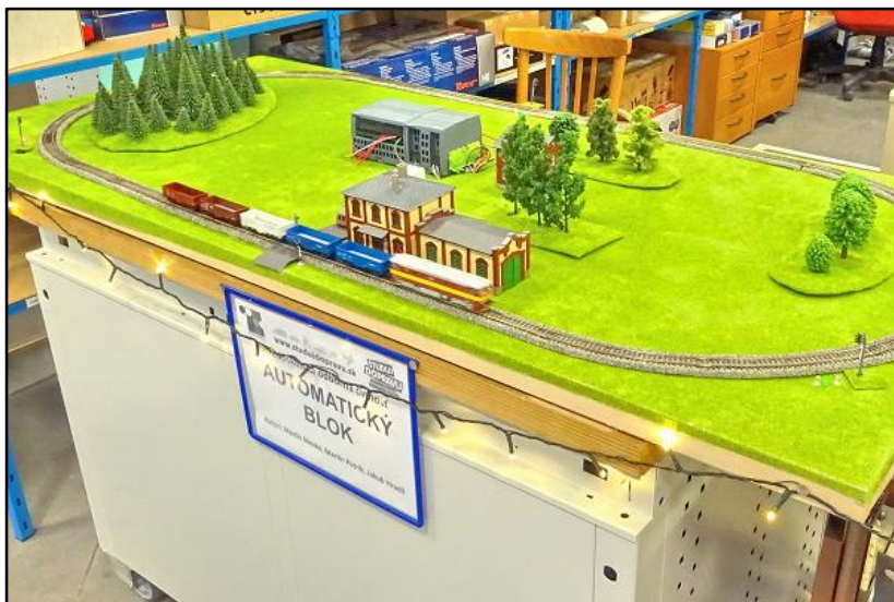
Vozidlá žiakov v prevádzke na koľajisku TT s automatickým blokom ovládaným SIMATICom
