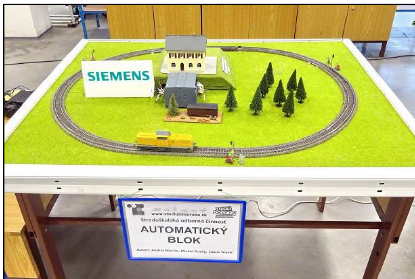
Prenosné koľajisko veľkosti H0 ovládané SIMATICom zhotovené žiakmi SPŠ dopravnej v Trnave v roku 2016
